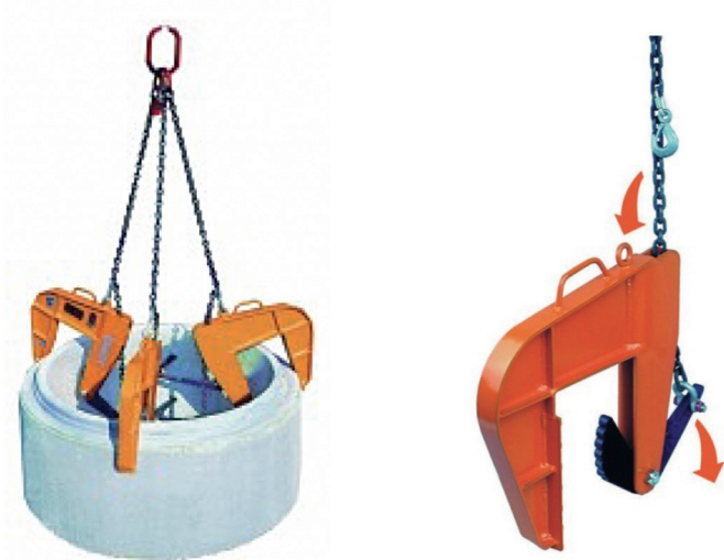
Rohrgehänge zum Auf-/Abladen und Versetzen von senkrecht stehenden Betonrohren (gefertigt in statisch verwindungstreifem Kastenprofil)
