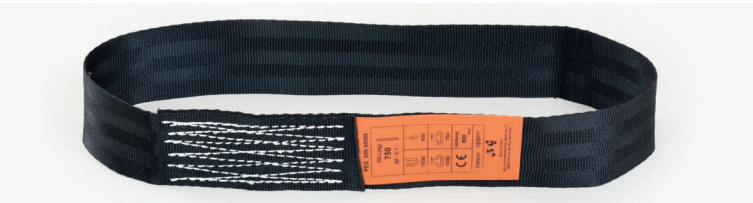
aus PES- Gurtband, 50 mm breit, als Endlosstrang vernäht Tragkraft bei 5-facher Sicherheit in Anlehnung an DIN EN 60005
