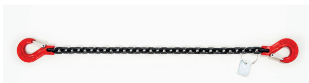
DIN EN 12195-3, Güteklasse 8, 2-teilig mit separatem Ratschenspanner
